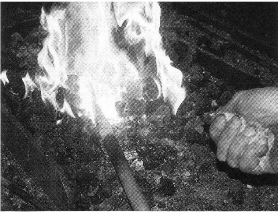
Bei Weissglut wird das Schweissgut mit Quarzsand bestreut.
