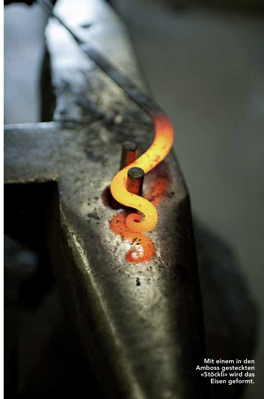
Im Feuer erhitzt Krähenbühl eine Eisenstange auf 1300 Grad.
